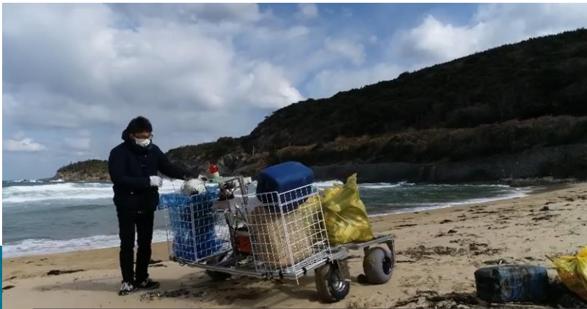
2022年に開発した、現場で組み立て可能、かつ砂浜での走行も可能な自律運搬ロボット
