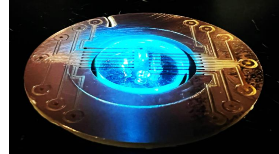
DNAデータストレージデバイス (初期設計時点)
