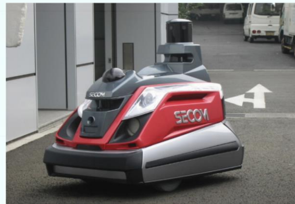
屋外巡回監視ロボット「セコムロボットX」
