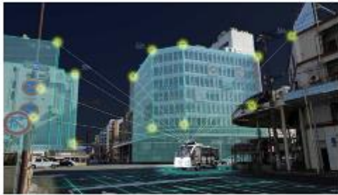
自動運転車両の自己位置推定におけるVPS（Visual Positioning System）活用
