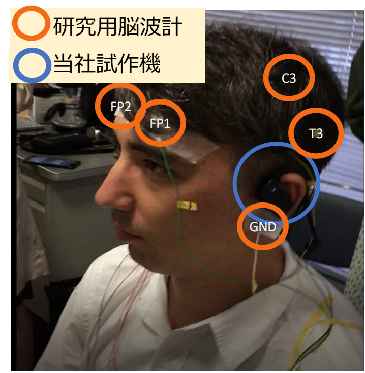
研究用脳波計との同時装着計測図
